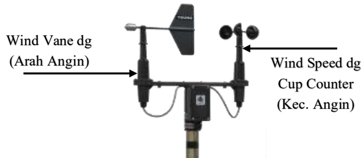
Gambar 28. Ada dua bagian yang terpasang diatas ting setinggi 10 meter
